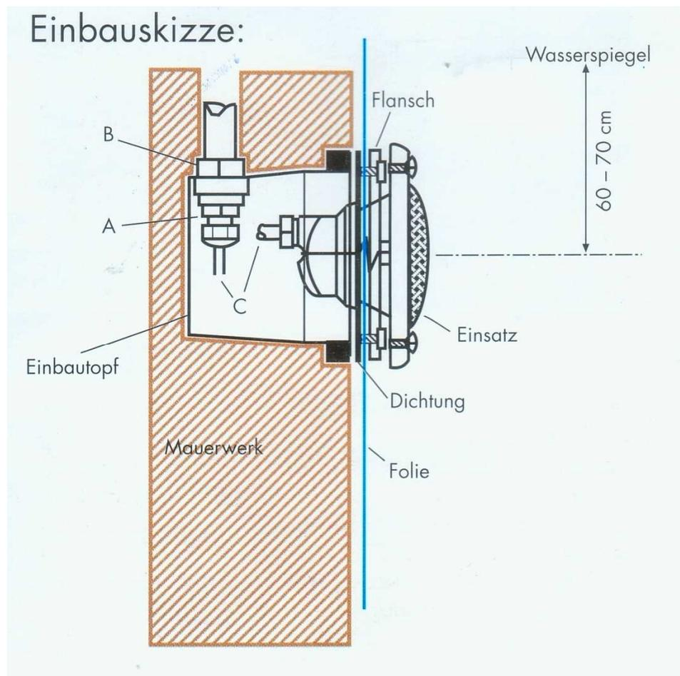
Bei der Montage des Unterwasserscheinwerfer-Einsatzes ist zu beachten, dass genügend Kabel auf denselben aufgewickelt wird. Dadurch kann ein Tausch des Leuchtkörpers vorgenommen werden, ohne den Wasserspiegel absenken zu müssen. Je nach Einbautiefe muss genügend Kabel verbleiben um den Scheinwerfer über die Wasserlinie heben zu können (siehe Einbauskitze Punkt C). Mit den beiden Schrauben (Stückliste 13) fixieren Sie den Scheinwerfereinsatz.
